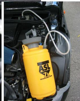
Pomper sur le pulvérisateur afin de mettre l'air sous pression. (pression entre 1 et 3bars, quand la pompe commence a durcie, cela suffit).
