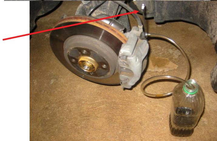
Au cours de cette étape, il est primordial que **l'air ne rentre pas dans l'étrier**. Si des bulles d'air sortent avec le liquide lors de la purge, il faudra purger jusqu'à éliminer **TOUTE BULLE D'AIR.**
