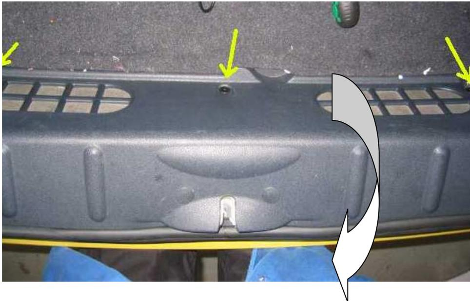
Il y a 3 clips le long du plastique sur la partie supérieure. Puis faire basculer dans un mouvement de rotation le plastique afin de le dégager du système de fermeture.
